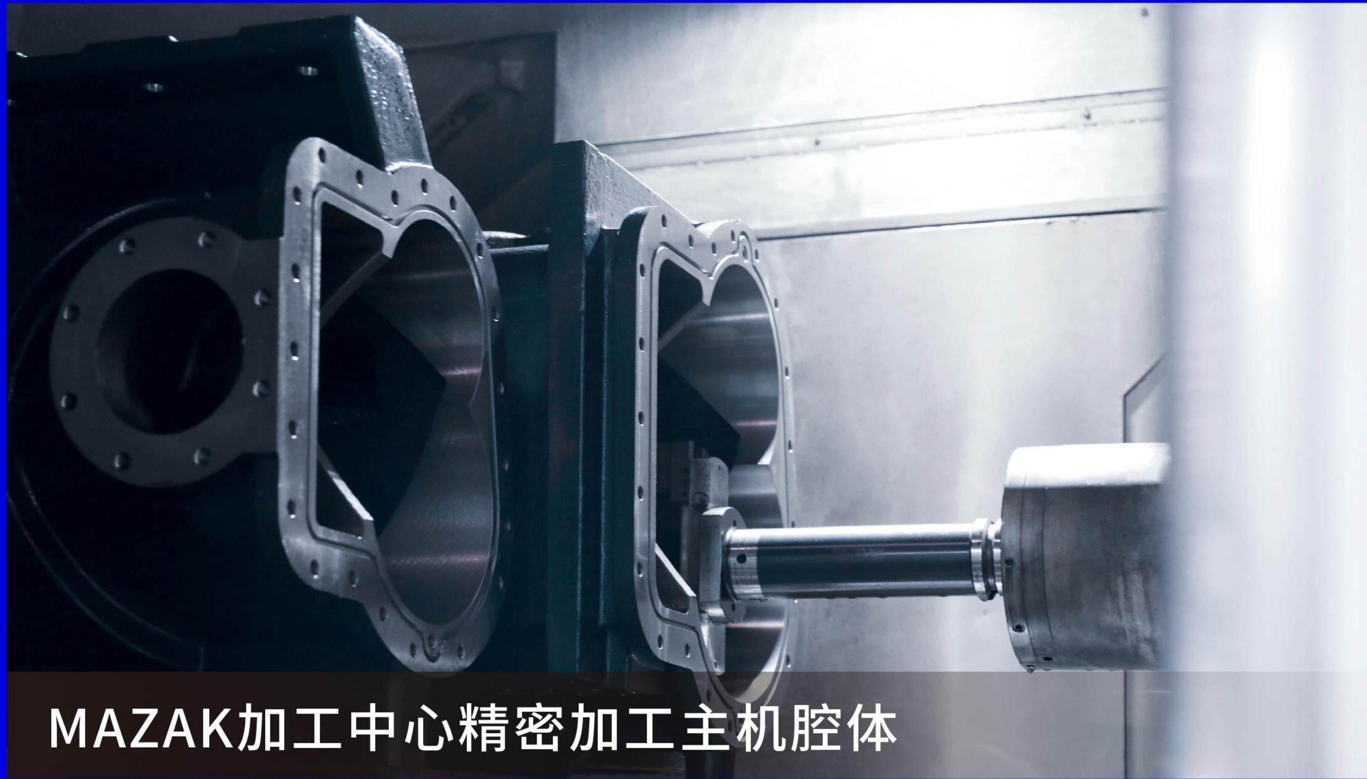
MAZAK加工中心精密加工主机腔体
